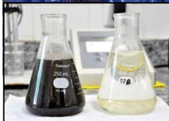
Tecnologia sofisticada, que inclui oxigenação, desnitrificação e nanofiltração, faz o chorume virar água, que pode ser usada para hidratar plantas e vias
